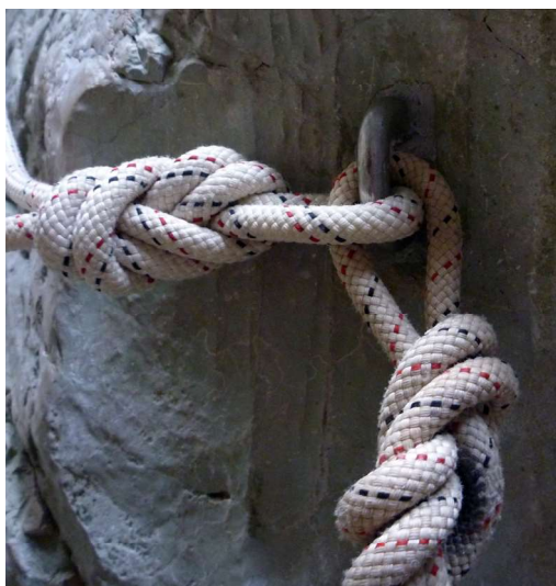
▲ Unión de cuerda en un anclaje químico (sin mosquetón).
