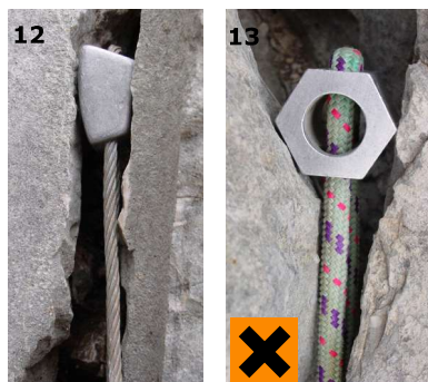
▲ Empotradores: (12) Colocación correcta; (13) Colocación incorrecta.
