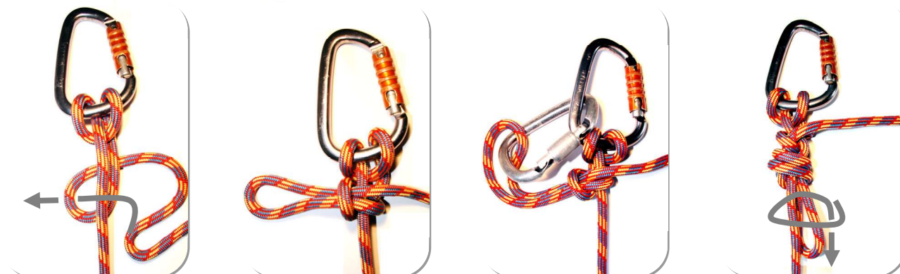
▲ Nudo de bloqueo del nudo dinámico.
