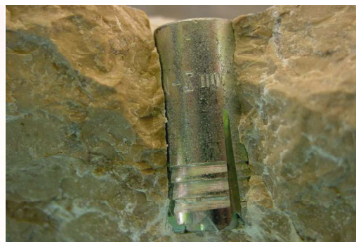
▲ Partes de un taco autoperforante y detalle una vez instalado en la roca.
