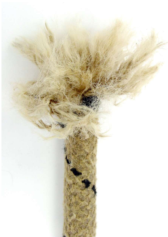
▲ Cuerda con más de 10 años, donde se aprecia el alto desgaste de las fibras.
