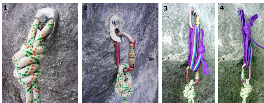
▲ Placas: (1) Sin mosquetón; (2) Con mosquetón; (3-4) Sistemas para evitar brazos de palanca.
