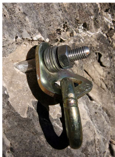
▲ Anclajes en malas condiciones debido a la corrosión y a una defectuosa colocación.
