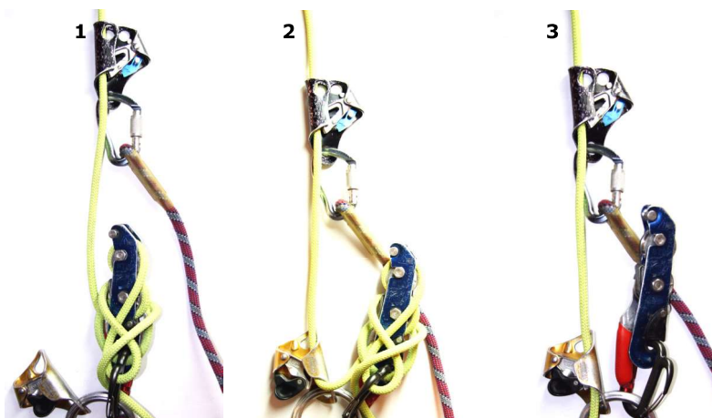
▲ Maniobra para cambiar de descenso a ascenso.
