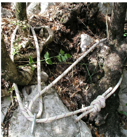
▲ Repartidor de carga con dos anclajes naturales.
