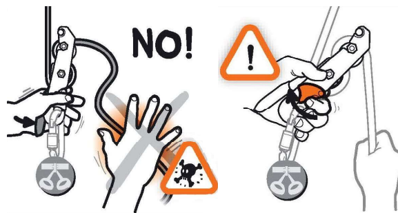
▲ No soltar la cuerda ni accionar el gatillo.
